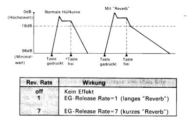
Wenn der AR-Wert des 1. Operators 0 beträgt, klingt die Note nach der Tastenfreigabe sehr langsam aus, da der EG-Pegel des 1. Operators unter der Reverbschwelle liegt. Ist der RR-Wert des 1. Operators bereits kleiner als der der REVERB RATE, fällt das Pseudo-Reverb unter den Tisch. Tragen Sie also beim Programmieren dieses Parameters den EG-Werten der einzelnen Operatoren Rechnung.
