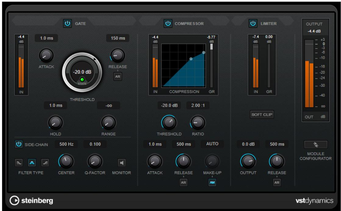
Das Fenster ist in drei Bereiche gegliedert, die Regler und Meter für die Effekte enthalten. Aktivieren Sie die einzelnen Effekte mit den **Gate**-, **Compressor**- und **Limitier**-Schaltern. Mit dem Schalter **Module Configurator** können Sie zwischen drei verschiedenen Routing-Optionen wählen.
