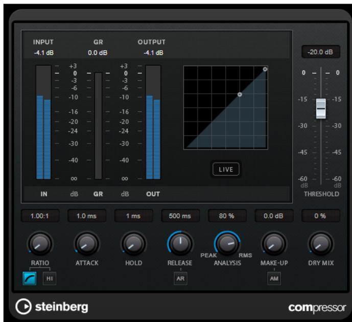
Der **Compressor** verfügt über eine separate Anzeige, die die Kompressorkurve darstellt, welche gemäß den Einstellungen der Parameter **Threshold** und **Ratio** geformt ist. Darüber hinaus bietet der **Compressor** ein Pegelreduktionsmeter (**Gain Reduction**) in dB, die Kompressionsmodi **Soft Knee**/**Hard Knee** sowie einen Schalter für eine automatische, programmunabhängige **Release**-Einstellung.
