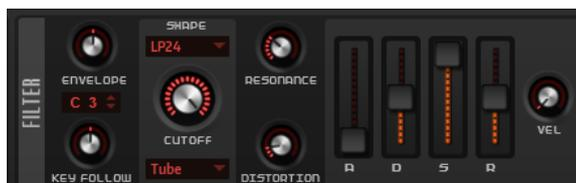
Mit der Filterhüllkurve können Sie viele Modulationsziele modulieren, auf die in der Modulationsmatrix zugegriffen werden kann.
