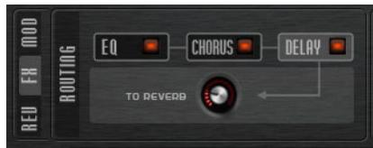
「ROUTING」セクションには、信号の流れが示されます。信号は、最初に EQ を通り、次にモジュレーションエフェクトを通ってから、ディレイエフェクトに流れます。「TO REVERB」コントロールを使用して、処理済みの信号のうち、グローバルリバーブエフェクトに送る割合を指定できます。
