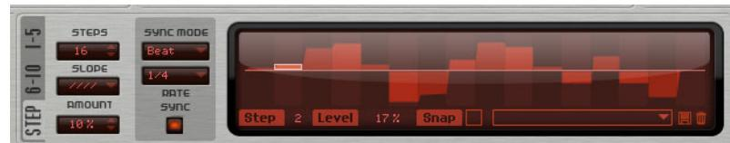
Padshop enthält einen polyphonen Step-Modulator, mit dem Sie rhythmisch gesteuerte Sequenzen erzeugen können. Eine Sequenz besteht aus maximal 32 Steps (Schritten).
