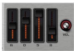
「VEL」コントロールはペロシティーがエンベロープの強さに影響する程度を設定します。0に設定するとエンベロープがそのまま適用されます。値が大きくなると、ペロシティーが弱いほどエンベロープの強さが低減されます。
