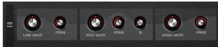
Für jedes Layer ist ein qualitativ hochwertiger 3-Band-Equalizer verfügbar. Das mittlere Band ist ein Glockenfilter, das tiefe und das hohe Band sind Kuhsschwanzfilter. Das mittlere Band ist vollparametrisch mit den Parametern Gain, Frequency und Q.
