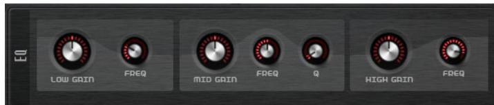
Tiene disponible un ecualizador de 3 bandas de alta calidad para cada capa. La banda de rango medio actúa como filtro de pico y las bandas baja y altas como filtros shelving (limitadores). La banda de rango medio es totalmente paramétrica, con ganancia, frecuencia, y factor Q ajustables.
