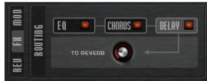
La section Routing (routage) montre le parcours du signal. Le signal traverse d'abord l'égaliseur, puis l'effet de modulation et enfin le delay. La commande "To Reverb" (vers la reverb) vous permet de doser le niveau de signal traité à être transmis vers l'effet de reverb global.
