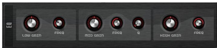
各レイヤーで、高品質な 3 バンドのイコライザを使用できます。中域の 2 つはピークフィルターの働きをし、低域と高域はシェルビングフィルターの働きをします。中域が完全にパラメトリックになっており、ゲイン、周波数、および Q を設定できます。
