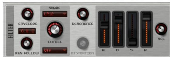
La sezione Filter consente di regolare il colore tonale del suono.
