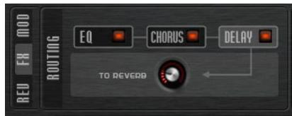
La sección de enrutado muestra el flujo de la señal. La señal pasa por el EQ primero, luego por el efecto de modulación, y luego por el efecto de retardo. Con el control "To Reverb", puede especificar la cantidad de señal procesada que se envía al efecto global de reverberación.
