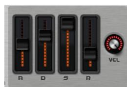
El control Velocity determina cuánto depende de la velocidad la intensidad de la envolvente. Cuando el control está en 0, se aplica el envolvente en su totalidad. Valores más altos reducen la intensidad para velocidades más bajas.
