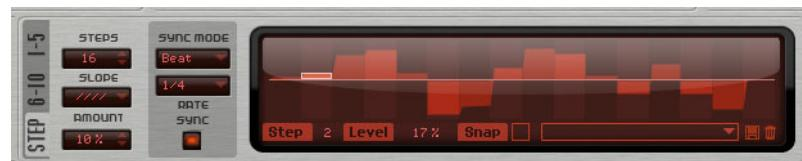
Padshop est doté d'un modulateur pas à pas polyphonique qui vous permet de créer des séquences de contrôle rythmiques. Chaque séquence peut comporter jusqu'à 32 pas.
