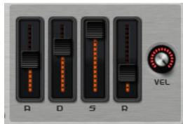
La commande de vitesse détermine la relation entre la vitesse et l'intensité de l'enveloppe. Quand cette commande est configurée sur 0, l'enveloppe s'applique intégralement. Avec des valeurs plus élevées, plus la vitesse est faible, plus l'intensité de l'enveloppe baisse.
