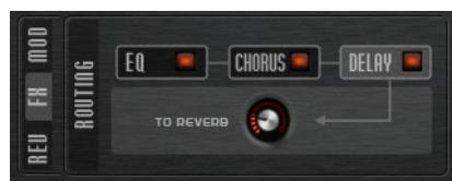
Im Routing-Bereich wird der Signalfluss angezeigt. Das Signal durchläuft zuerst den EQ, dann den Modulationseffekt, gefolgt vom Delay-Effekt. Mit dem Regler »To Reverb« können Sie einstellen, wie viel des bearbeiteten Signals an den globalen Reverb-Effekt geleitet werden soll.
