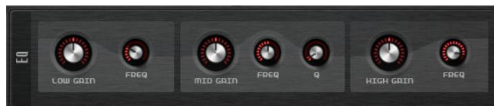
Per ciascun layer è disponibile un equalizzatore a 3 bande di elevata qualità. La banda media agisce come un filtro di picco, mentre le bande bassa e alta come filtri shelving. La banda media è completamente parametrica, con guadagno (gain), frequenza (freq) e fattore Q regolabili.
