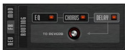
La sezione Routing visualizza il flusso del segnale. Il segnale passa prima nell'EQ, poi nell'effetto di modulazione e infine nell'effetto delay. Tramite il controllo "To Reverb" è possibile specificare la quantità di segnale processato che viene inviata all'effetto di riverbero globale.
