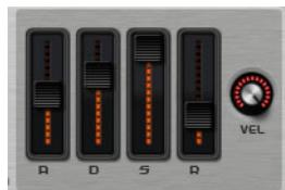
Das Velocity-Bedienelement bestimmt, inwieweit die Hüllkurvenintensität von der Anschlagstärke abhängt. Bei der Einstellung »0« wird die gesamte Hüllkurve angewendet. Höhere Werte verringern die Intensität bei geringeren Anschlagstärken.
