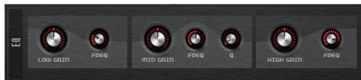
Chaque couche est dotée d'un égaliseur à 3 bandes de haute qualité. La bande moyenne joue le rôle de filtre à formant et les bandes basse et haute de filtres à étage. La bande moyenne est entièrement paramétrique et son gain, sa fréquence et son facteur Q peuvent être réglés.
