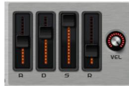
Il controllo Velocity determina il grado con cui l'intensità dell'inviluppo dipende dalla velocity. Quando il controllo è impostato su 0, l'inviluppo viene applicato completamente. Valori più elevati riducono l'intensità per le velocity più basse.
