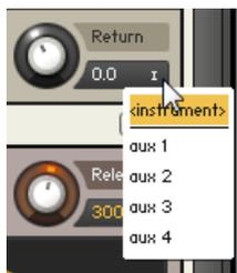
Sie können die Effektsignale vom Ausgangskanal Ihres Instruments isolieren, indem Sie die Ausgangszuweisung Ihrer Send-Effekte verändern.
