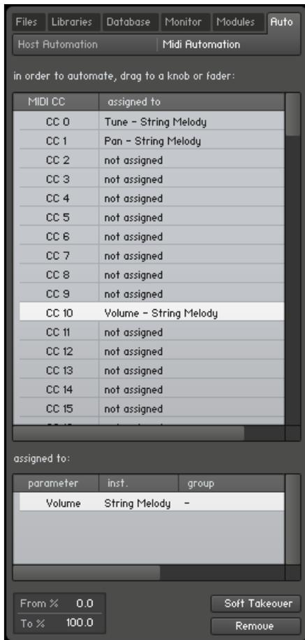
Die MIDI-Automationsseite zeigt eine Liste zuweisbarer MIDI-Controller in der oberen Hälfte sowie Details der ausgewählten Zuweisung in der unteren Hälfte an.
