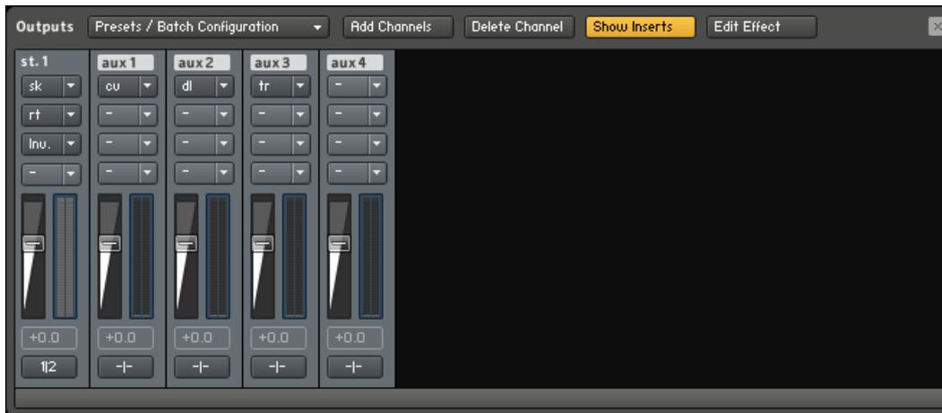
Module, die Sie in einem Output-Kanal einfügen, verarbeiten die Signale aller Instrumente, die diesem Kanal zugeordnet sind.
