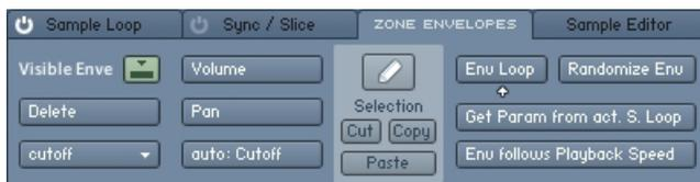
Auf dem Zone Envelopes-Tab finden Sie von links nach rechts Auswahl- und Löschfunktionen, Zuweisungs-Schaltflächen, Bearbeitungswerkzeuge sowie diverse Hilfsfunktionen.
