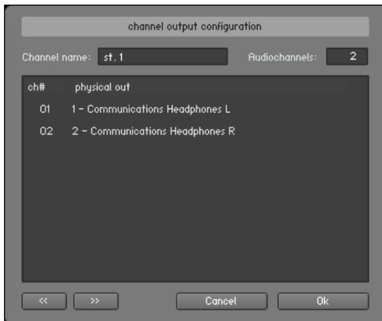
Im Konfigurationsdialog eines Kanals können Sie die Anzahl der Audiosignale und die dazugehörige Zuordnung physikalischer Ausgangskanäle bearbeiten.
