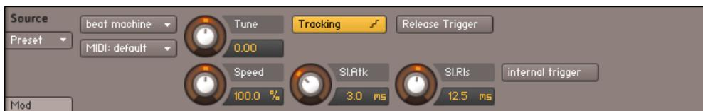
Der Modus „Beat Machine“ sollte nicht manuell aktiviert werden; es ist besser, zunächst die Samples im Wave Editor mit Slice-Markierungen zu versehen und ihn dann mittels der Schaltfläche „Use Beat Machine“ auf dem Sync / Slice-Tab einzuschalten.
