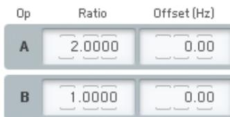
**Frequency Ratio** definiert das Frequenzverhältnis eines Operators zur Grundton der gespielten Note. Eine Einstellung von 1.0000 bedeutet, dass die Frequenz des Operators exakt dieser Frequenz entspricht. 2.000 setzt die Frequenz auf die erste Harmonische (1 Oktave höher), 3.000 auf die dritte Harmonische (Oktave + Quinte) und so weiter. 0.5000 ist die Subharmonische eine Oktave unterhalb des Grundtons.
