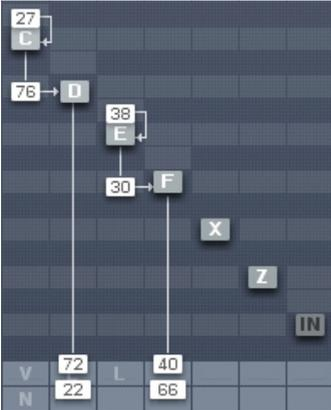
Bitte beachten Sie, dass der **Audio-Eingang** ebenfalls auf der **FM-Matrix** verfügbar ist. Sie können das Eingangssignal also als Modulator und Carrier nutzen, wie bei jedem normalen Operator. Dies ergibt sehr interessante Möglichkeiten für den Einsatz des FM8 als Effektgerät.
