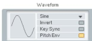
Jeder Operator kann eine von 32 Wellenformen wiedergeben. Im alten DX7 standen lediglich Sinuswellen zur Verfügung. Klicken Sie auf den numerischen Wert bei der Wellenformanzeige und wählen Sie die gewünschte Wellenform durch Ziehen mit der Maus.
