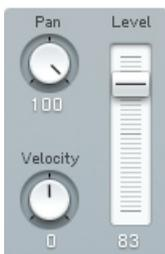
**Pan** spiegelt den Pan-Wert aus der untersten Zeile der FM-Matrix wider und bestimmt, an welcher Stereoposition das Signal des Operators im Ausgang zu hören ist. Ein Verschieben dieses Reglers wird den Wert in der Matrix ändern und umgekehrt.
