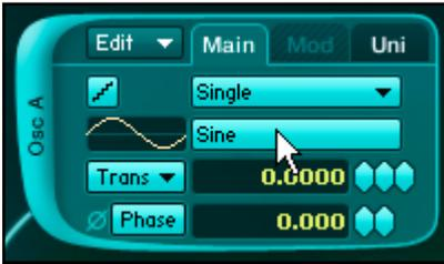
Das Waveform-Menü des ersten Oszillators zeigt Sine (Sinus) als geladene Wellenform an.
