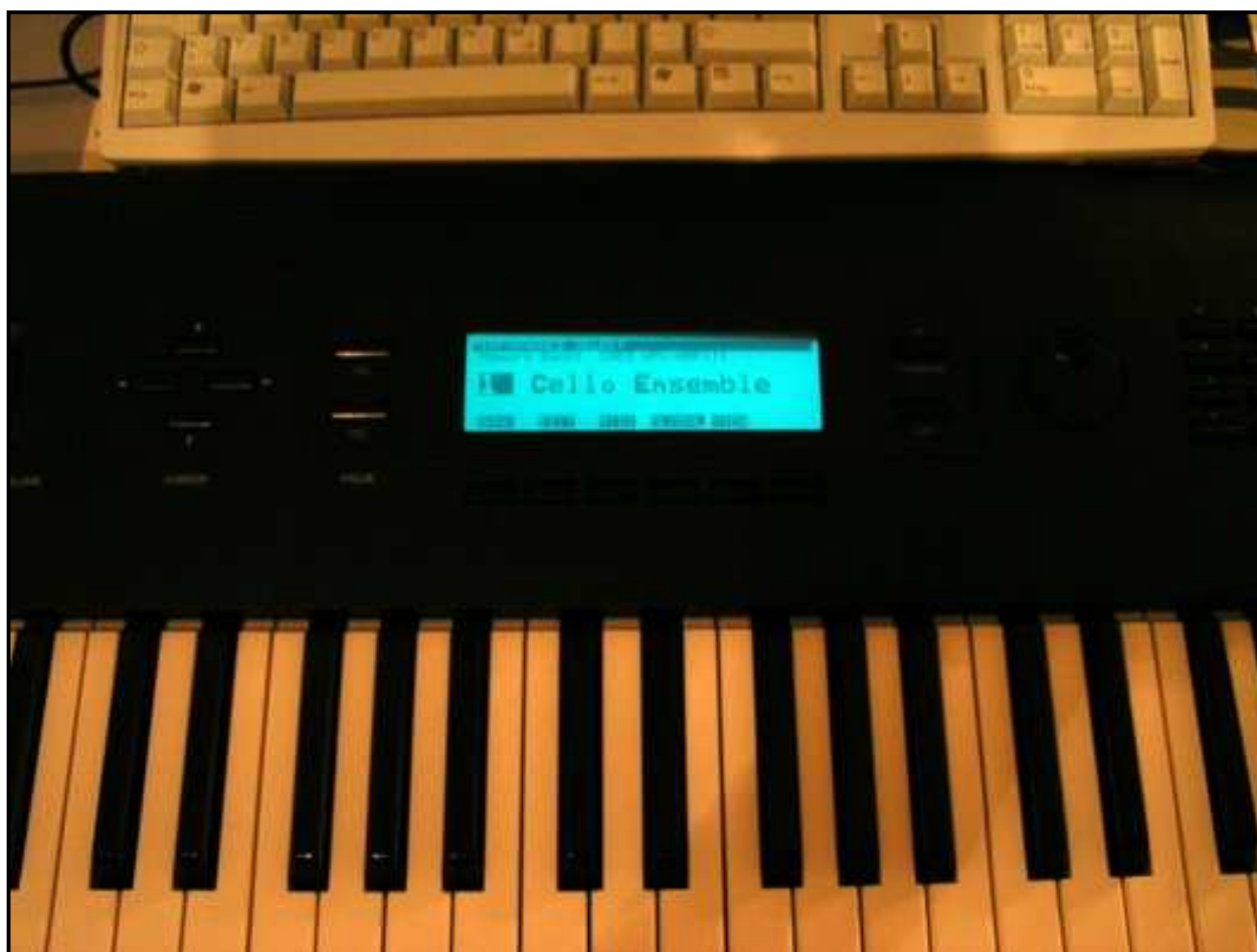
Korg Wavestation EX mit neuem Backlight
