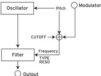
Die Modulation eines Filter-Cutoffs mit einem LFO erzeugt einen Effekt, der an ein Wah-Wah-Pedal erinnert. Filter FM erzeugt einen Höchstgeschwindigkeits-Wah-Effekt. Die Cutoff-Frequenz wird von den Signalen eines oder mehrerer Modulatoren moduliert, wobei das Oszillatorsignal als Audio ins Filter geleitet wird. Wie im Filtermodus wird die Zentralfrequenz der Modulation mit der Oszillator-Tonhöhe synchronisiert, wobei der Parameter „CUTOFF“ einen Versatz hinzufügt.
