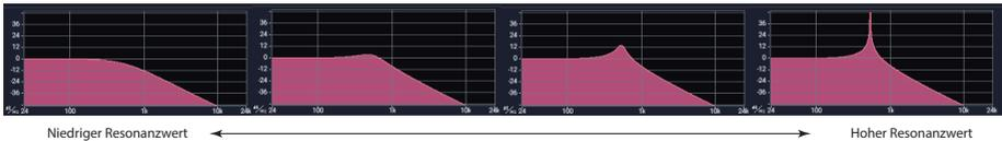
**Hinweis:** Bei manchen Filtertypen kann innerhalb des Filters eine Oszillation auftreten, wenn für RESO (Resonanz) ein zu hoher Wert eingestellt ist. Dies kann zur Folge haben, dass die Oszillation auch nach Note-off weiterläuft. Um diese Art Oszillation zu vermeiden, können Sie mit V.Patch den Resonanzwert mit einem Hüllkurvengenerator steuern oder einen Filter auf der Seite Operator Mode nutzen.
