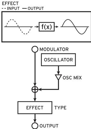
In diesem Modus arbeitet der Operator als Effekt wie ein Delay, Kammfilter oder Verzerrer. Das Signal vom Oszillator und das Eingangssignal des Modulators werden in den Effekt eingegeben. Der Parameter OSCMIX regelt den Eingangspegel des Oszillators. Je nach gewähltem Effektyp stehen unterschiedliche weitere Effektparameter zur Verfügung.
