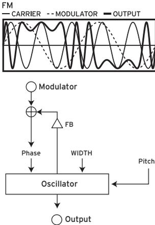
Wird zum Beispiel der LFO verwendet, um die Tonhöhe anzuheben und zu senken, hören Sie einen Effekt, der einem Vibrato ähnelt. FM (Frequenzmodulation) ist ein Höchstgeschwindigkeitsvibrato. Das Signal des Modulators moduliert die Phase eines Oszillators, indem es dessen Tonhöhe schnell anhebt und senkt. (Diese Arbeitsweise entspricht der des Korg VPM Klangerzeugers sowie der von typischen Synthesizern).
