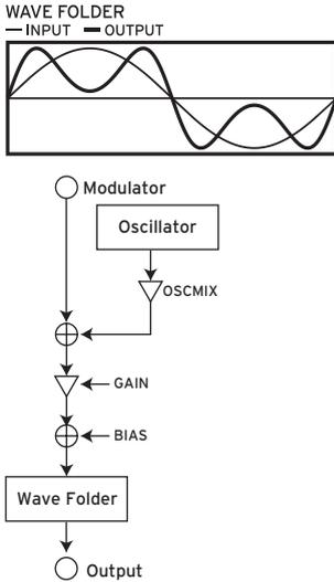
Dieser Effekt wirkt sich auf die Wellenform aus. Das Wellenfaltungsmodul erzeugt Harmonische durch Invertieren der Wellenform der Signale von Oszillator und Modulator bei einer festen Schwelle. Der Parameter „OSCMIX“ regelt den Anteil des ins Wellenfaltungsmodul geleiteten Oszillatorsignals.
