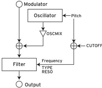
Dieses Filter verfügt über eine Tastenverfolgungsfunktion. Die Signale von Oszillator und Modulator(en) werden in das Filter geleitet. Der Parameter „OSCMIX“ regelt den Anteil des ins Filter geleiteten Oszillatorsignals. Die Cutoff-Frequenz wird mit der Oszillator-Tonhöhe synchronisiert, wobei der Parameter „CUTOFF“ einen Versatz hinzufügt.
