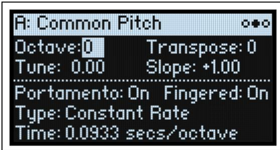
Diese Einstellungen gelten für das gesamte Program, inklusive Oszillator 1/2 und Suboszillator. Drücken Sie **PITCH**, um diese Seite aufzurufen.
