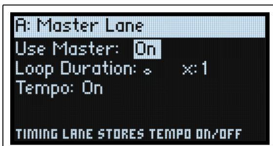
Wenn „Use Master“ auf „On“ gestellt wurde, startet die Master-Zeile alle anderen Zeilen nach der eingestellten Schlaganzahl bzw. Dauer neu. **TEMPO** (siehe unten) hat hierauf einen Einfluss. Hiermit sorgen Sie bei Bedarf dafür, dass sich alle Pattern in regelmäßigen Schritten wiederholen, selbst wenn die Zeilen unterschiedlich lang sind.
