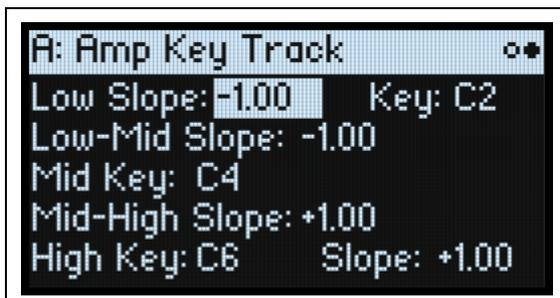
Die Lautstärke wird von der Tastenskalierung („Key Track“) beeinflusst und richtet sich nach der Tonhöhe. Hiermit sorgt man für eine ausgewogene Balance der Noten – oder gerade für spezielle Effekte.
