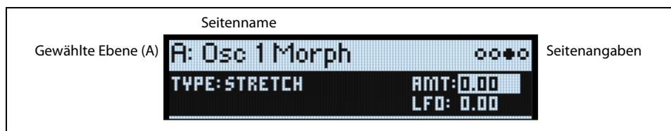
**LAYER A/B:** Jede Ebene enthält ein Program, einen Arpeggiator und weitere Einstellungen. Es kann jeweils eine Ebene editiert werden, die man mit diesen Tastern wählt. Um eine Ebene ein-/auszuschalten, halten Sie **SHIFT** gedrückt, während Sie einen LAYER-Taster betätigen (bzw. auf einen Taster doppelklicken).
