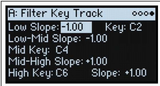
Die meisten akustischen Instrumente klingen in höheren Lagen immer brillanter. Das kann man nachbilden, indem mit dem „Keyboard Track“-Parameter (Notenskalierung) die Frequenz eines Tiefpassfilters bei zunehmender Tonhöhe immer weiter ansteigen lässt. In der Regel benötigt man zumindest eine Idee „Keyboard Track“, um eine natürliche Filteransprache zu erzielen.
