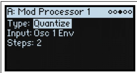
Dieser Parameter unterteilt ein durchgehendes Signal in mehrere Stufen. Hiermit kann die Form der LFO- oder Hüllkurven geändert oder dafür gesorgt werden dass die Steuerquelle nur auf bestimmten Werten „landet“.
