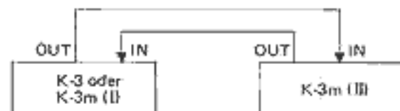
Beispiel: Editieren von Klangprogrammdaten des K-3m (II) über einen K-3 oder zweiten K-3m (I)
