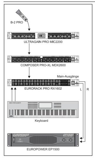
Abb. 3.4: Erweiterbares kleines Live-Setup
