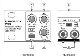
Abb. 2.1: Bedienungselemente der Kanalsektionen
