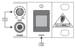
Abb. 2.3: POWER-Schalter, LEVEL-Regler und PHONES-Buchse
