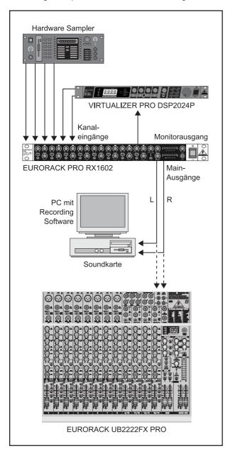
Abb. 3.2: Zusammenfassung von Sampler-Ausgängen
