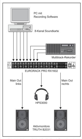
Abb. 3.3: Abhörmöglichkeit für Multitrack-Recorder oder Mehrkanal-Sound-Karten
