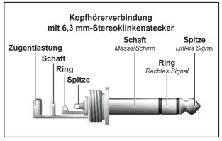
Abb. 4.3: 6.3-mm-Stereoklinkenstecker für Kopfhöreranschluss
