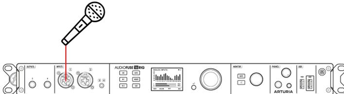
Mikrofone (insbesondere Bändchenmikrofone) erzeugen relativ schwache Signale, die als *Mikrofonpegel* bezeichnet werden. Sie erfordern die größte Verstärkung, damit sie deutlich gehört werden können. Daher ist es gut, dass die Mikrofonvorverstärker an den Eingängen 1 & 2 eine hohe Verstärkungsmöglichkeit bieten und dabei ein sehr geringes Eigenrauschen!
