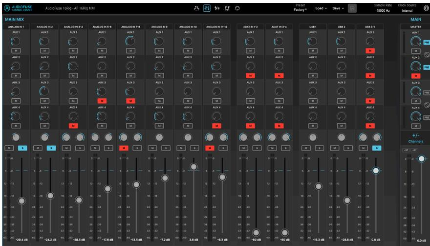
Jeder Kanal bietet über einen Sendpegelregler und einen **M** (Mute) für jeden Aux-Bus, eine Panorama-Einstellung, **M** (Mute) und **S** (Solo), ein Lautstärke-Fader und ein Meter mit Clip-Indikator.
