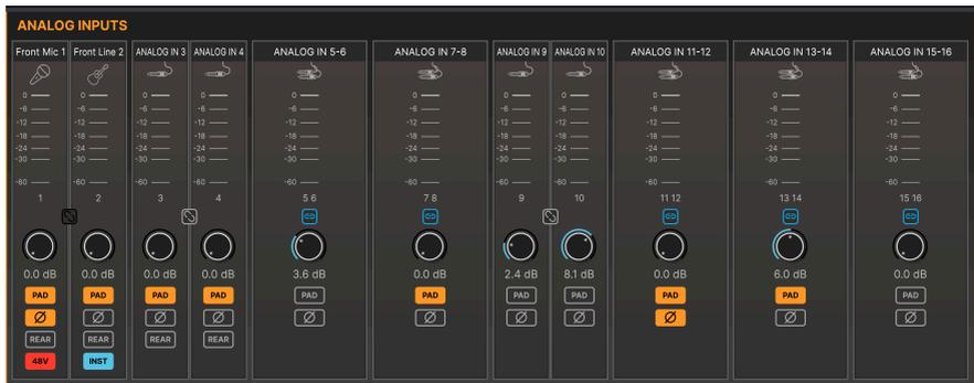
Der obere linke Abschnitt des Übersichts-Fensters enthält Anzeigen und Bedienelemente für die Analog-Eingänge. Diese duplizieren die Funktionen bei der Hardware, ermöglichen jedoch die gleichzeitige Anzeige aller Eingänge. Jeder Eingang verfügt über eine Pegelanzeige, einen mit dem benachbarten Eingang geteilten Stereo-**Link**-Taster, einen Gain-Regler und Taster für **Pad** und **Phase**.
