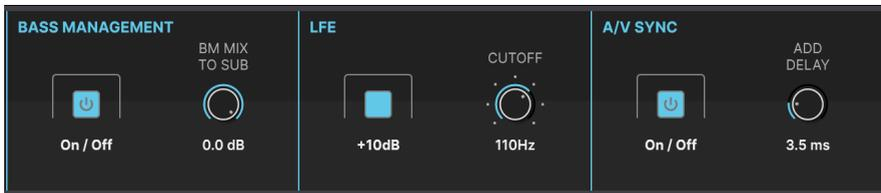
Diese Bedienelemente aktivieren/deaktivieren mehrere wichtige Funktionen eines Multichannel-Mixes und ermöglichen deren Einstellungen.
