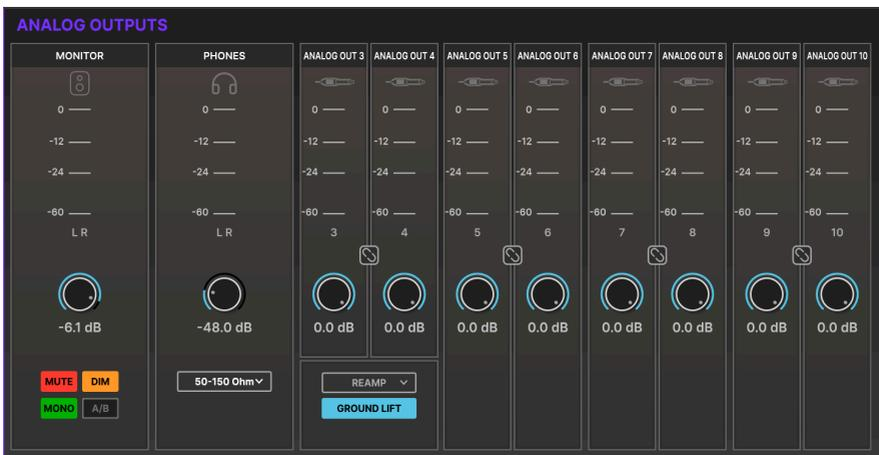
Im unteren linken Teil des Übersichts-Fensters befinden sich Bedienelemente und Pegelanzeigen für alle analogen Ausgänge. Jeder Ausgangskanal bietet ein Pegel-Meter, einen Stereo-Link-Taster zum Verbinden benachbarter Monokanäle und einen Ausgangspegelregler.
