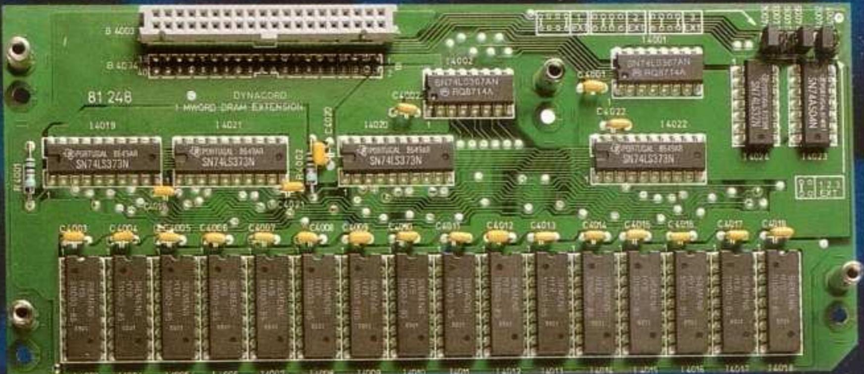
Mit den 2 MB-RAM-Extension Platinen kann der serienmäßige RAM-Speicher von 2 MB auf bis zu 8 MB (= 3 Platinen) ausgebaut werden. Der Gesamtspeicher hat dann eine Sampling-Kapazität von 92 sec. bei 20 kHz Bandbreite oder 184 sec. bei 10 kHz...
