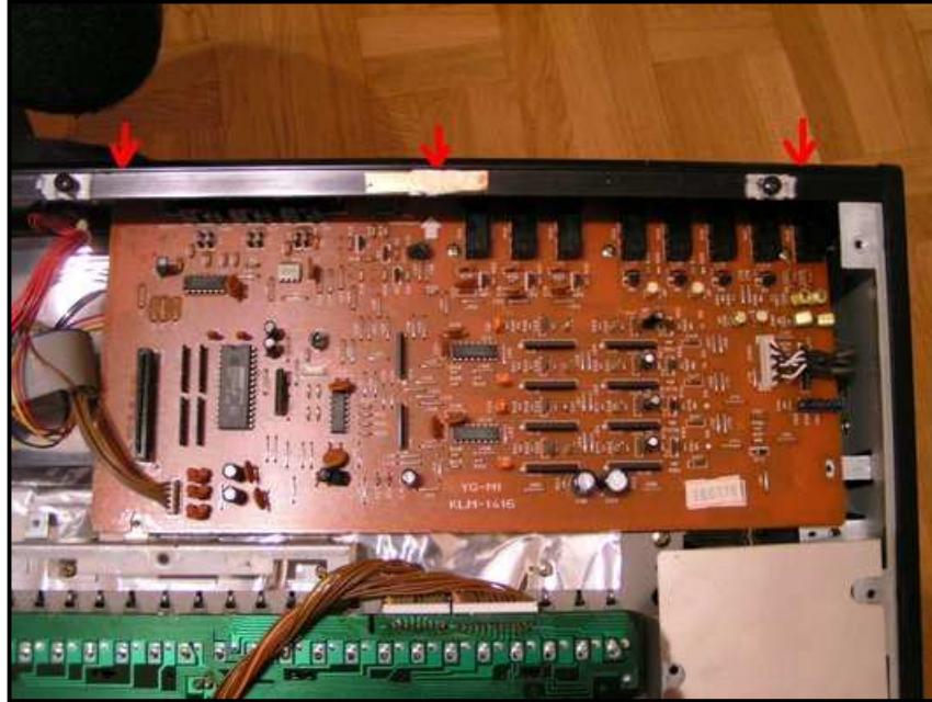
Schwarze Schrauben lösen und Mainboard KLM-1415D herausheben
