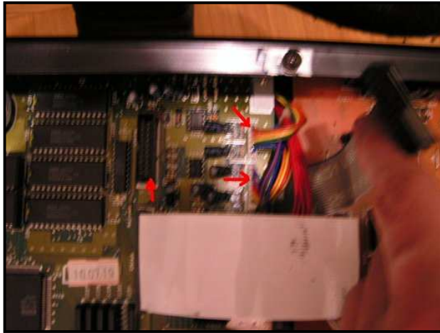
Kleines Flachkabel und 2 Stecker abziehen
