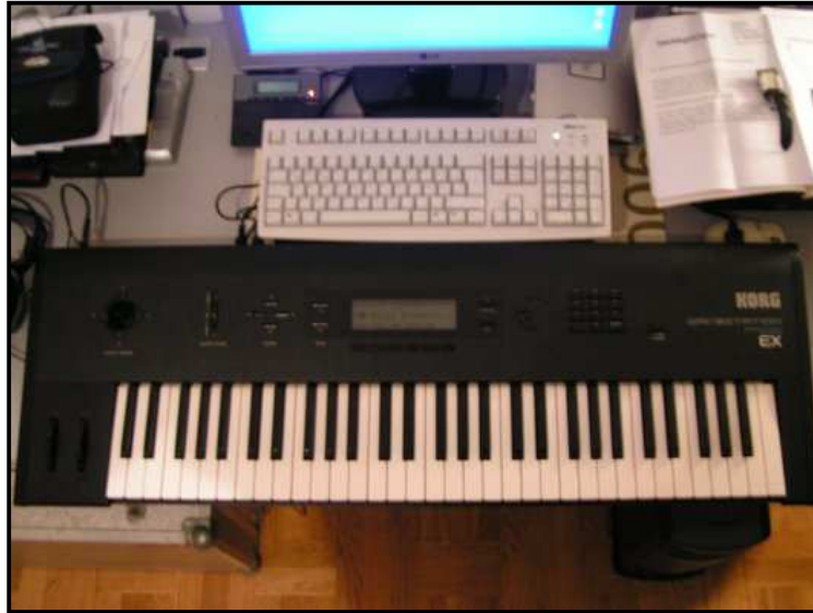
Wavestation EX mit erschöpfter Leuchtfolie
