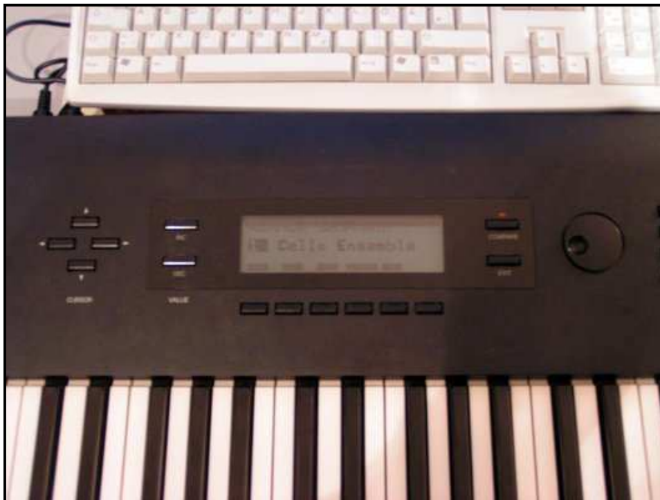
Displaybereich der Wavestation EX mit erschöpfter Leuchtfolie
