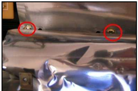
Folienschrauben unter der Tastatur
