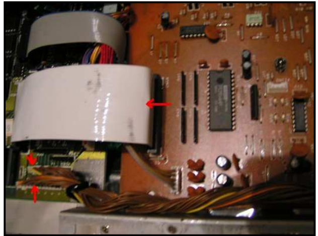
Großes Flachkabel und 2 Stecker abziehen
